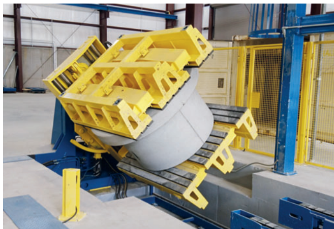
Для погрузки и разгрузки изделий с защитой от всплывания была установлена автоматическая кантовательная станция
