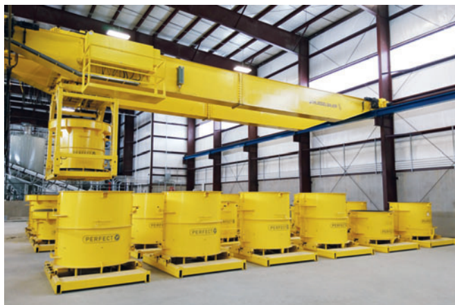
Формы перемещаются с помощью роботизированного крана
