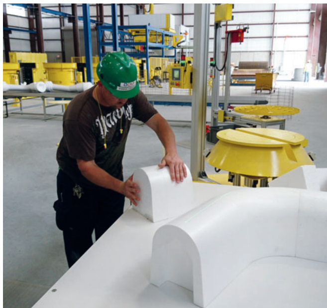
Заготовки раскаиваются с помощью термопроволочного резака и собираются в негативы водоводов
