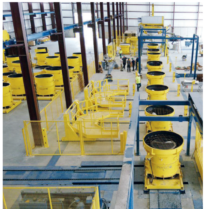
Производственная система Perfect Forming Technology на заводе CP&P в Эшленде обеспечивает самое эффективное производство монолитных колец с днищем в стране
